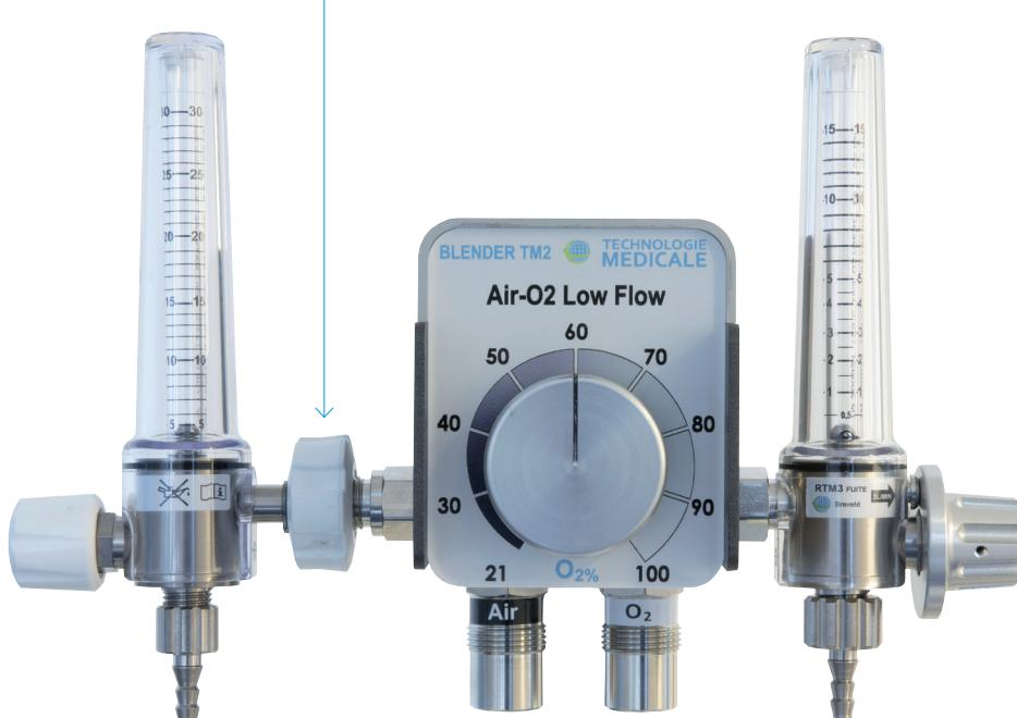
Réglage de la concentration en  $\text{O}_2$  (en %) ( $\text{FiO}_2$ ). De 21% à 100 %. Précision du % d' $\text{O}_2$  : +/- 5 % de la pleine échelle. Norme suivant NF EN ISO 11195.
